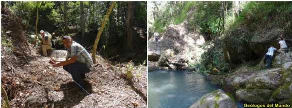
*Replanteo en terreno. Toma de cotas relativas mediante la nivelación mediante cuerda-nivel y nivel de agua.*
